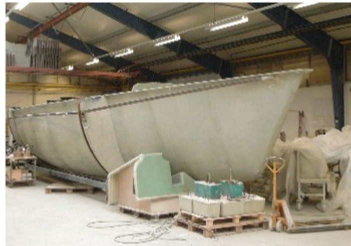
Form für den Rumpf eines Motorkrachers: Die Werft fertigt auch für andere Firmen.
