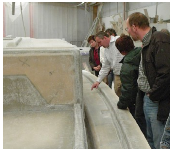
"Negativ denken um positiv zu arbeiten": Dies ist die Unterseite der Form für ein Deck.
