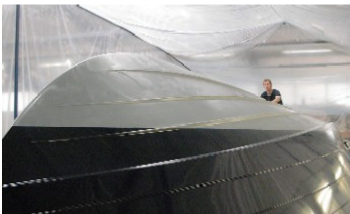
In der Entwicklungsabteilung: Ein handgefertigter Rumpf-Prototyp als Positiv-Vorlage für die spätere Form.
