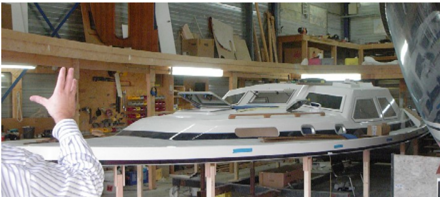
oben: Fast fertiges Deck in der Montage. Deck und Rumpf werden so weit wie's geht getrennt gebaut und erst ganz zum Schluss zusammen gesetzt.
