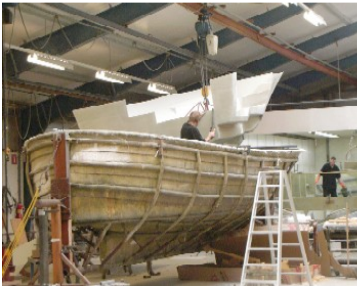
Fertig: Ein Rumpfteil verlässt die Form in der GFK-Fertigung.
